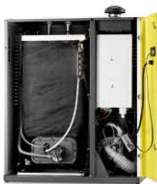
gaSteam配置了预混合燃气燃烧器，在密封仓内以负压运行，可做大范围调节。不锈钢热交换器精巧的设计可保证当前市场上最高的能效(高达96%)。系统采用的冗余传感器和控制器表明此款加湿器符合主要的国际安全标准。
