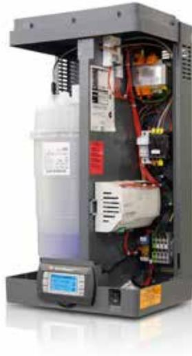
humiSteam可使用电导率在75~1250  $\mu\text{S}/\text{cm}$  的饮用水生产蒸汽，并且可根据供水的性质自动调整，优化运行时间。调节范围大(20%~100%)，且采用精巧的电子控制器可达到精确控制房间湿度；采用了限制传感器，可在任何情况中避免风道内形成冷凝。
