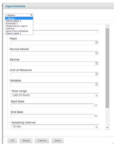
Les rapports peuvent être créés pour des installations entières, pour des modèles (tous les dispositifs comprenant ce modèle s'afficheront) et/ou pour un seul dispositif. Ces champs peuvent être utilisés individuellement ou combinés pour filtrer les variables qui nous intéressent et que l'on souhaite inclure dans le rapport. Il est également possible de filtrer par unité de mesure. Tous ces champs sont à sélection multiple.
