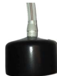
Cappuccio di calibrazione, IR-RS Diametro interno cappuccio: 42,8 mm Diametro interno tubo: 5 mm Nota: il cappuccio è dotato di quattro tagli uguali per consentirle di essere montata sul sensore IR-RS come mostrato sotto. Impiego: Unità IP41 con sensore IR-RS
