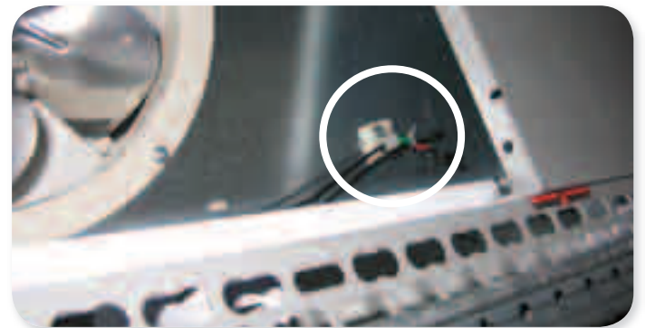
Todas as sondas duplicadas foram instaladas para medir o mesmo valor de temperatura/pressão
