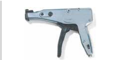
2) 在绑线拉力工具上(代码CM00000006)设定拉力为250N (工具指数上的位置6);
