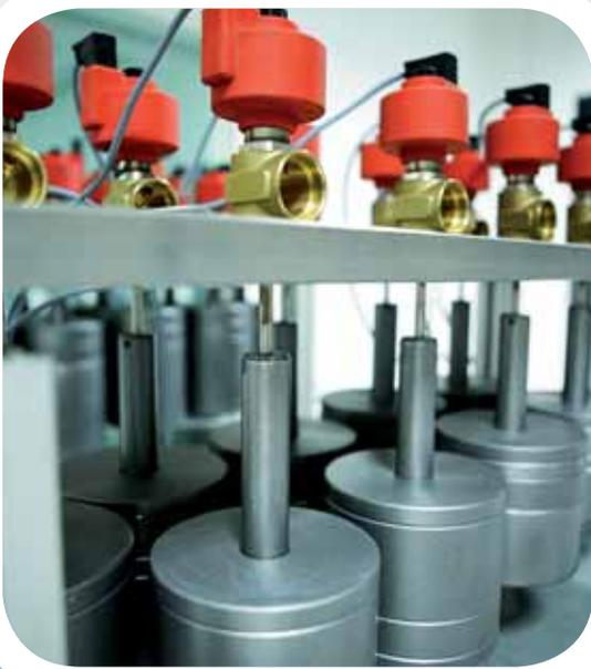
Специалисты компании CAREL проверяют надежность работы вентилях серии E<sup>V</sup> в самых неблагоприятных условиях, смоделированных в собственных лабораториях.
