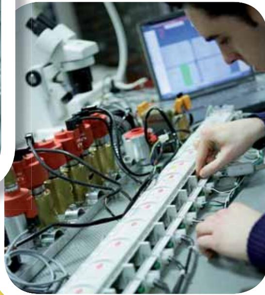
Компания CAREL гарантирует высочайший уровень качества выпускаемой продукции: каждый вентиль проходит серьезные испытания, включая проверку работоспособности и герметичности.
