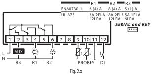
IxxxY(0,7) H (N,C) (0,2)xx senza/without R3 IxxxY(0,7) H (A,L) (0,2)xx Corrente massima totale su terminale 3: 12A Maximum current on terminal 3: 12 A
