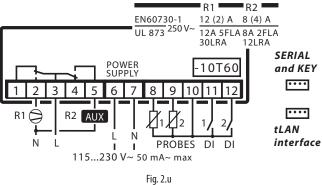
IxxxS(0,7) (0,L) (N,C) (0,2)xx senza/without R2 IxxxS(0,7) (0,L) (A,L) (0,2)xx Corrente massima totale su terminale 3: 12 A Maximum current on terminal 3: 12 A
