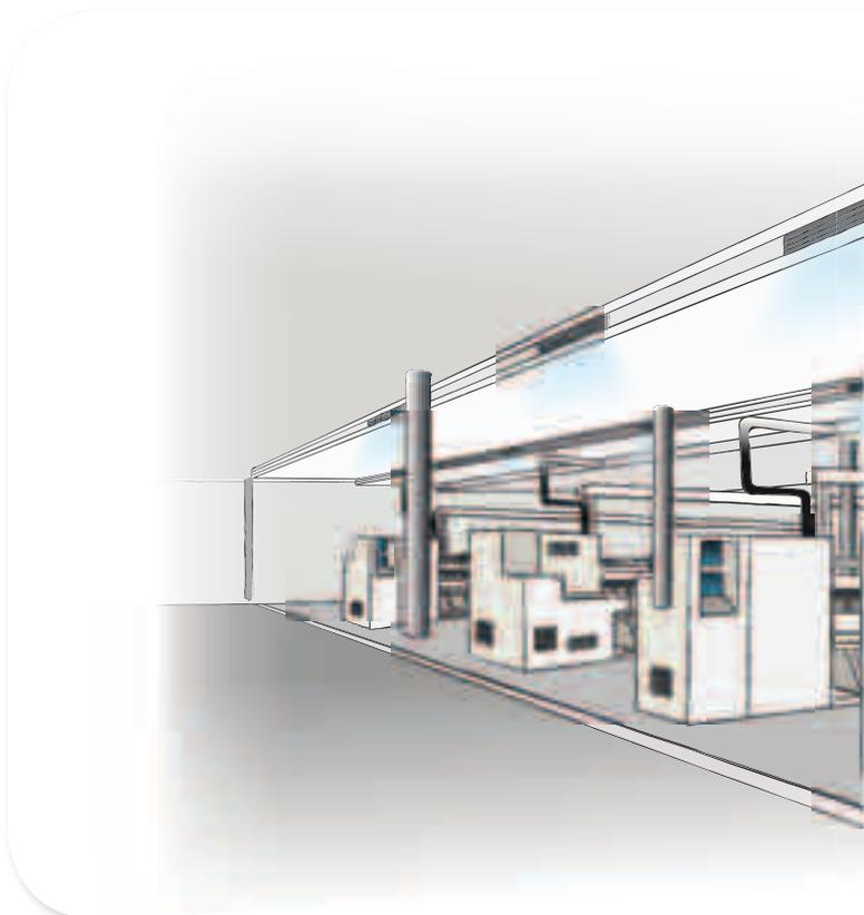
Il funzionamento a doppio stadio è garantito da un controllo CAREL ir33 universale collegato a una sonda di umidità a parete. ChillBooster è adatto per tutte le applicazioni che richiedono una grande capacità di umidificazione, fino a 1000 l/h. L'apparecchio usa una pompa per mettere in pressione l'acqua che gli ugelli atomizzano, producendo una nebulizzazione fine e uniforme. Le goccioline generate evaporano spontaneamente, umidificando e raffreddando l'aria.
