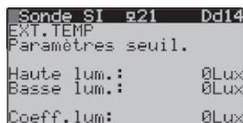
De la même façon pour le capteur SI on peut éditer un texte à 8 caractères pour l'identification du capteur; par rapport au capteur SA, il prévoit en plus la détection de la luminosité ambiante pour laquelle, dans cet écran, on peut paramétrer des seuils d'alarme de type Haute ou Basse luminosité; et un coefficient pour l'ajustement de la valeur lue qui, par défaut est paramétrée sur 1000; sauf exigence particulière, il est conseillé de ne pas modifier ce paramètre.
