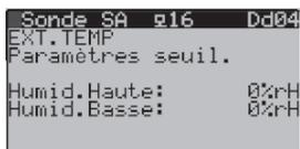
Un seuil pour l'alarme de Haute et de Basse humidité peut être paramétré dans cet écran. On ne dispose pas ici de paramètre pour une valeur sur la lecture de l'humidité ambiante.
