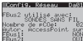
On peut décider de quel type de dispositif sera connecté au réseau FieldBus2 intégré. On peut sélectionner 'CAPTEURS SANS FIL' ou bien 'pCOe'. Puis, le nombre de pCOe connectés, puis activer ou non les Points d'Accès sur chaque FieldBus.
