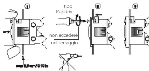
Con clips de montaje (con 02 clips)
