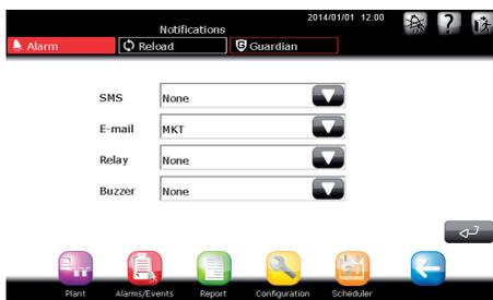
Outre les canaux de notification, le Guardiano permet de configurer les alarmes qui, lorsqu'elles ne sont pas notifiées, doivent déclencher un signalement alternatif. En fonction aussi d'un paramètre de temps.
