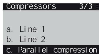
Nel caso di Linea di compressori posizionati in parallelo viene dunque gestita da una scheda aggiuntiva (in pLAN o connessa tramite DI/DO):
