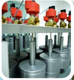
CAREL EXV电子膨胀阀已经由 CAREL实验室在最严格的运 行条件下进行了使用寿命的 测试。
