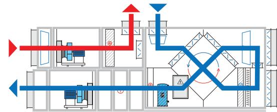
должна продолжаться по датчику влажности, необходимо открыть соленoidный клапан конденсатора на притоке, пока температура не достигнет уставки.
