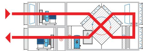
поворачивает в секции рециркуляции. После секции рециркуляции воздух подогревается в пластинчатом рекуператоре и попадает на конденсатор теплового насоса, где подогревается и подается в помещение. Если мощности нагрева TH недостаточно для компенсации тепловых потерь помещения, то подключается водяной нагреватель.
