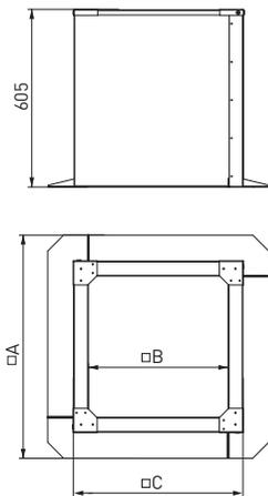
Стакан монтажный предназначен для монтажа крышных вентиляторов дымоудаления и крышных осевых вентиляторов подпора на кровле зданий. Стакан монтажный MSN — представляет собой жесткую сварную конструкцию, состоящую из участка сварной трубы квадратного сечения и нижнего опорного основания. Стаканы монтажные утепленные MSN-U — имеют в своей конструкции термо-шумоизолирующий материал, который предназначен
