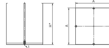
Поддоны предназначены для сбора и удаления конденсата, образующегося на металлических элементах вентилятора или монтажном стакане за счет конденсации воздуха, для защиты от дождевых осадков в помещениях с сухим режимом. Линейка поддонов представлена 8 типоразмерами. При монтаже размер «Н» может регулироваться посредством крепления поддона к отверстиям на подвесе, расположенным на разной высоте. Данная кон-
