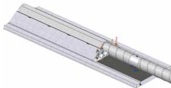
Рис. 26. Пример: прямое подключение воздуха, вертикальное подключение воды
