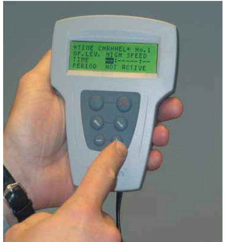
Все установки, наладки и считывания производятся на желаемом языке в меню ручного терминала
