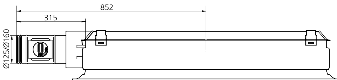
Рис. 43. Монтаж с заслонкой Присоединение воздуха на короткой стороне. Смонтированная заслонка SYST CRPc 9-125/160
