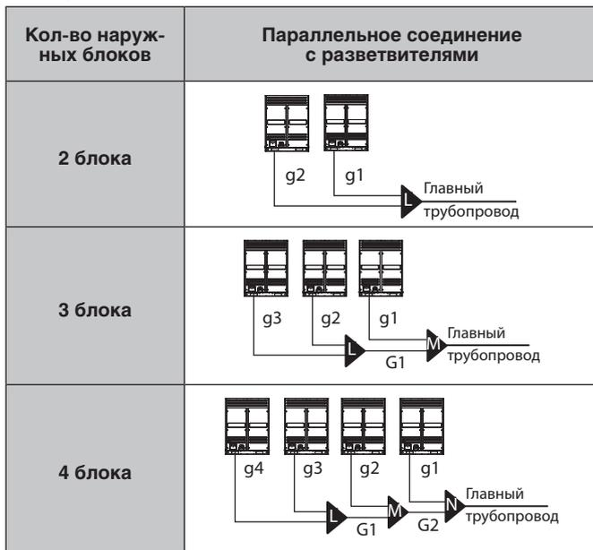
**Диаметр соединительного трубопровода наружных блоков**
