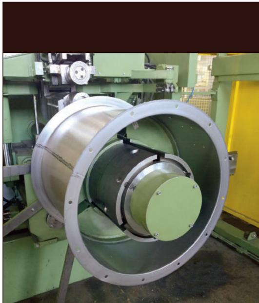
История создания осевых вентиляторов для удаления горячих газозвудушных продуктов на ООО «ВЕЗА» начинается с 2013 года. Конструкторским отделом ООО «ВЕЗА-БРЯНСК» разработаны и внедрены в производство **ОСА®-ДУВ**. Образцы прошли опытные натурные испытания в высокотемпературной воздушной среде.
